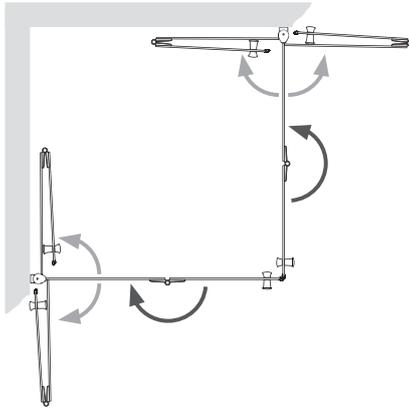
Durch die FALTBAREN DUSCHWÄNDE wird der Duschraum zum erweiterten Badezimmer. Das äußerste Türteil wird zuerst nach außen gefaltet, dann können beide Türteile bis ganz an die Wand weggeschwenkt werden.
