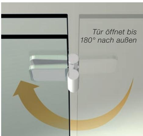
Das Scharnier ermöglicht das Öffnen der Tür um 180 Grad nach innen und außen, bis es am Fixteiglas anliegt. Auf diese Weise bietet es mehr Bewegungsspielraum im Bad, die Duschtür steht Ihnen nie mehr im Weg. Das ist konsequente Barrierefreiheit auch im kleinen Bad!
